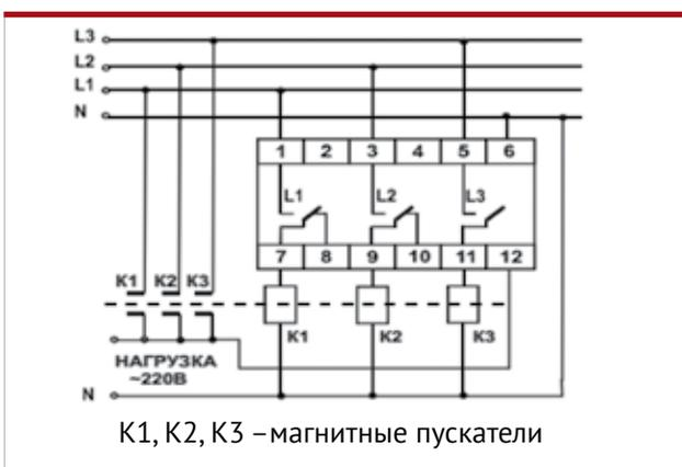
▶ В OptiDin ПЭФ-301 предусмотрена внутренняя блокировка от залипания контактов выходных встроенных реле, а также контроль состояния силовых контактов МП во внешней цепи (блокировка от их залипания, используется клемма 12).
